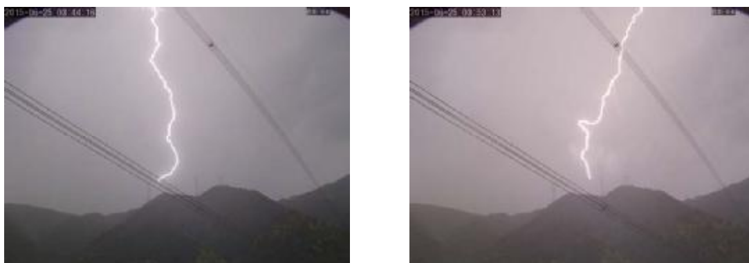
图 C.1 输电线路雷击光学图像监测结果
